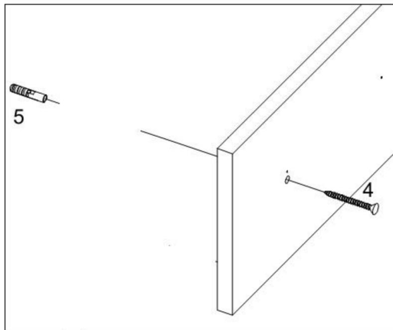
Просверлить в стене отверстия  $\varnothing 8$  мм и глубиной 40 мм, забить в них дюбеля (5). Установить вешалку в стене и завернуть в дюбеля шурупы (4).
